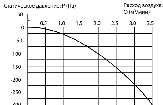
Расход приточного воздуха (подача воздуха в блок)
